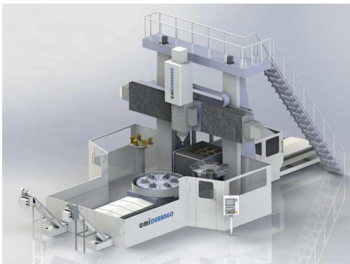
Centro de mecanizado multiprocesos que da la posibilidad de hacer tanto trabajos de fresado como de torneado en la misma máquina, de grandes dimensiones, evitando tiempos de procesos largos.
